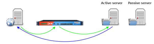
Le client (dans ce cas, le serveur Web), se connecte au serveur NFS actif à travers l'**ALOHA**. Le serveur NFS répond en direct au client, passant outre le Load-Balancer.
